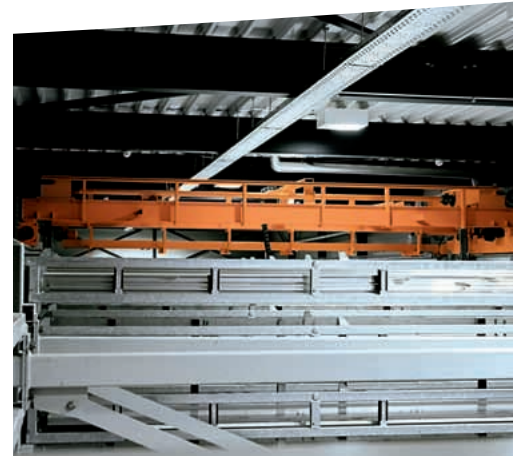
Überfahrlager für kundenseitige Gestelle in der Fensterproduktion.
