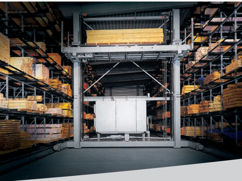
UNIGRIP: für mittlere Lagergrößen das ideale Waben-Langgutlager.
