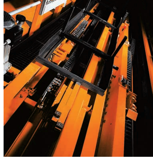
Regalbediengerät mit Zugeinrichtung für den zuverlässigen Kassetten-Transport.
