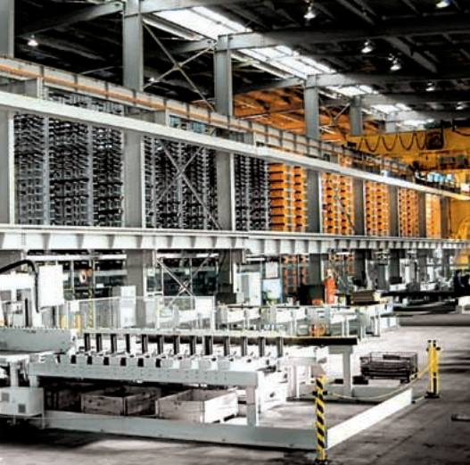
Sägezentrum mit Bandsägemaschine und Palettierertechnik bei einem Stahlhändler in Japan.
