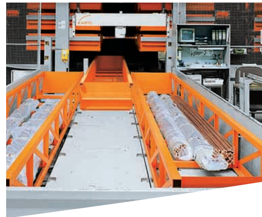
Kommissionierstationen mit minimierten Kassettenwechselzeiten gewährleisten eine kontinuierliche Produktion.
