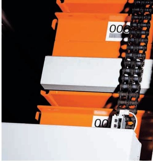
Für höchste Zuverlässigkeit: Hubkette mit Schlaffkettensicherung.
