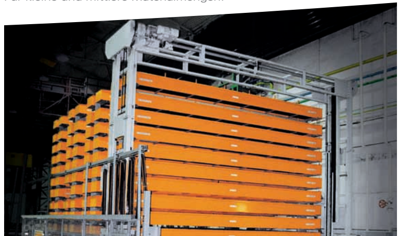
UNIPORTAL : Kassettenlager mit sehr guter Raumnutzung. Für kleine und mittlere Materialmengen.
