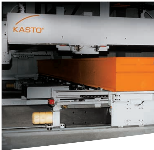
In Verbindung mit einem Unterfahrwagen wird das Langgutlager UNITOP zu einem schnellen Kommissioniersystem.
