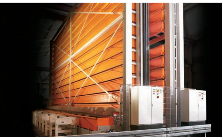
UNITOWER : Kompakt-Kassettenlager für Langgut, Kisten und Paletten.
