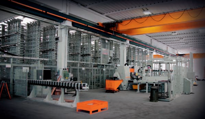
KASTOcenter: Kombiniertes Lager-Säge-System mit Markieren und Palettieren.
