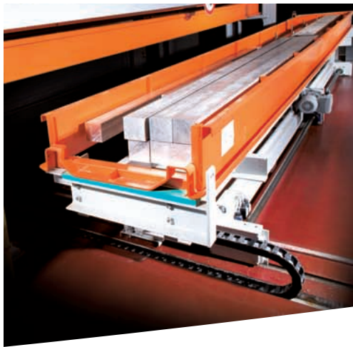
Querstation zum stirnseitigen Bereitstellen der Kassetten.
