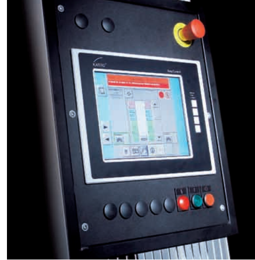
Bedienerfreundliche Steuerung EasyControl , vorbereitet für die Anbindung an das kundeneigene EDV-System.
