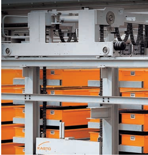
Das Kettenhubwerk des Regalbediengerätes: robust und langlebig.
