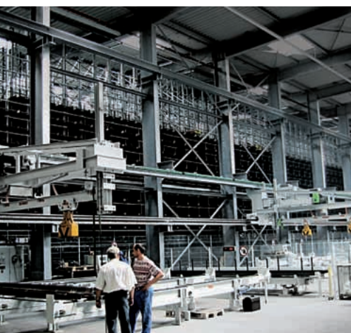
Kommissioniergerät mit Magnetanlage und Kettenförderer für rationelles Kommissionieren.
