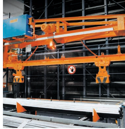
Das Kommissioniergerät ermöglicht eine ergonomische und schnelle Materialentnahme.
