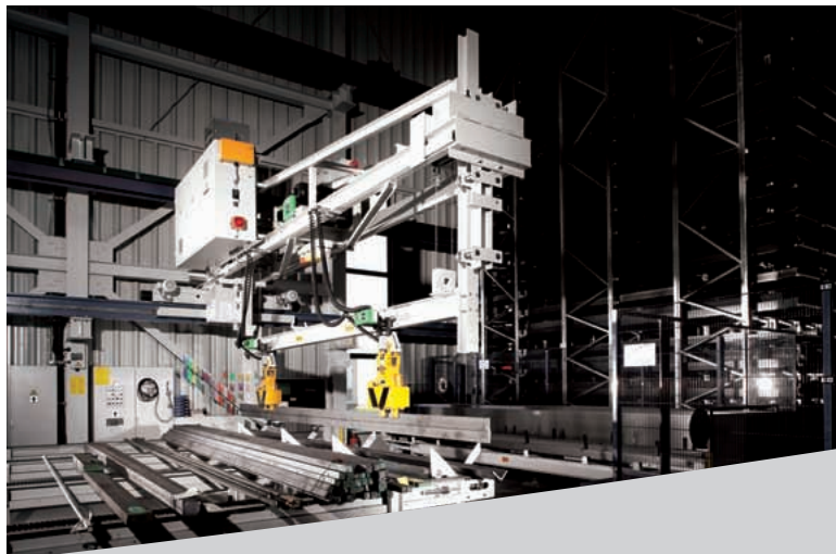
Stationsperipherie mit Kommissioniergerät mit Magnetanlage und Kettenförderer mit kippbarer Kommissioniermulde.
