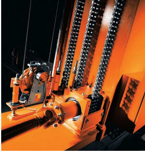
Wartungsarm und langlebig: Regalbediengerät mit Kettenhubwerk.
