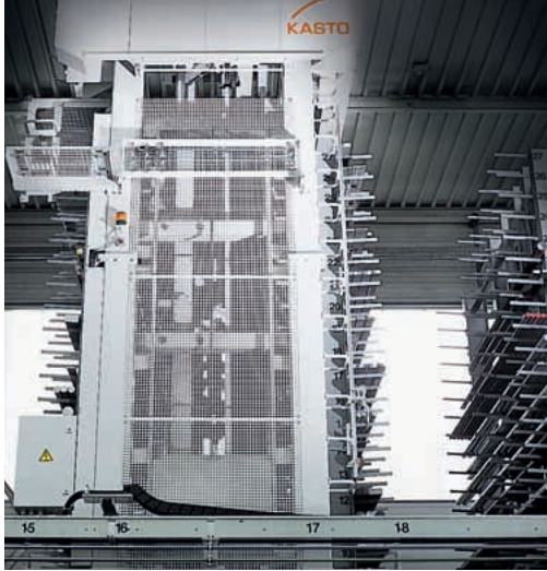
Regalbediengerät in Portalbauweise mit Wartungsteg.
