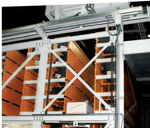
Überfahrlager UNITOP mit Tunnel für Transportwagen.
