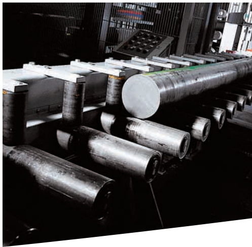
Auslagerrollenbahn für den Materialtransport zu stationären oder Beistell-Sägemaschinen.
